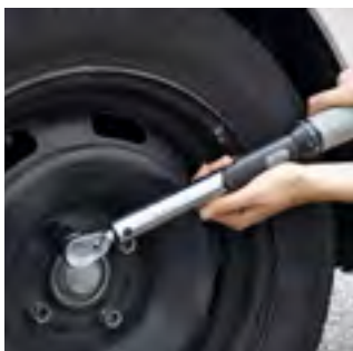
005 060 - UV.1 Clé dynamométrique - 119Nm
